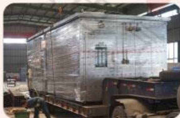
北京燕山分公司三废联合装置 凝结水在线监测分析系统
